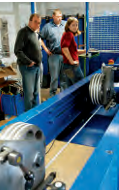
Auf der hydraulischen Streckbank wurden die Bruchlastwerte ermittelt.
