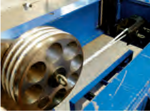
Die Festmacher mit Augspleiß und Palstek wurden ebenfalls hydraulisch unter Zug gesetzt und zerrissen.
